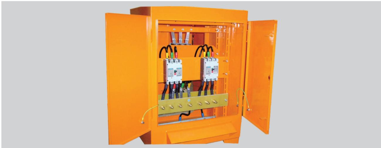
X M 照明配电箱适用于建筑住宅、宾馆、车站、医院、办公室及工厂企业等现代化建筑物,供户内使用。用以分配交流5 0 H z 、4 1 5 V 以下的单相、三相四线、三相五线的照明及小型动力控制回路,作线路过负荷、短路、漏电保护,满足用户多功能需要。照明配电箱分为明装和暗装两种结构形式,具体尺寸根据用户的要求及安装元器件的数量确定。
